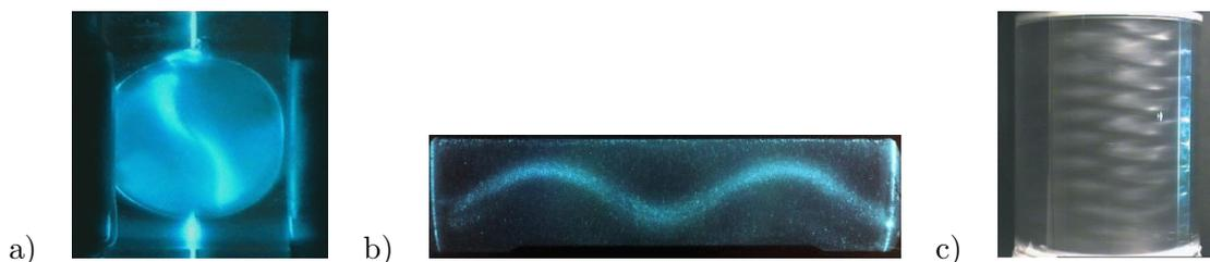
FIGURE 1 – a) Visualisation de l'instabilité elliptique dans une sphère en rotation déformée par une marée [2] et b) dans un cylindre déformé [3] ; c) Visualisation de l'instabilité strato-rotationnelle dans un dispositif de Taylor Couette avec stratification axiale de densité [4].
